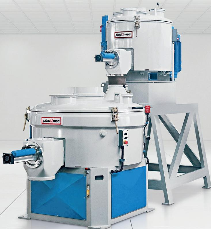
COMBIMIX RV es la combinación del mezclador de calor TRM y el enfriador vertical RFV.
