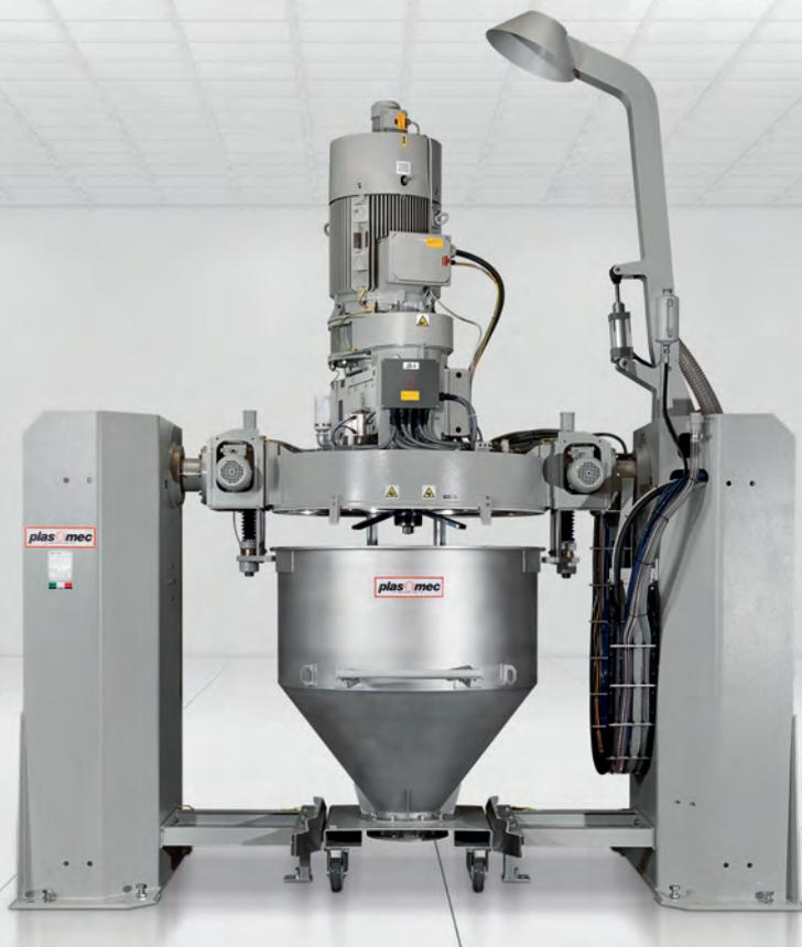
当生产要求高度灵活和产品类型广泛的混合，TRR翻料罐式混合机是传统涡轮式混合机的理想替代品。
