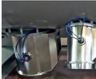
冷却水循环换热器
