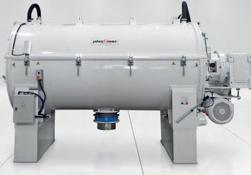
HEC系列冷混机是生产硬质PVC或增塑PVC干混料的理想解决方案。标准容量高达8500升。PLAS MEC最新创新开发和优化的冷混机，对于U-PVC从120° C降到40° C目前可以达到每小时8批次以上
