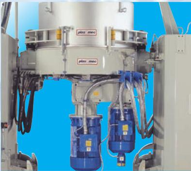
Antrieb über zwei Motoren mit variabel einstellbarem Geschwindigkeitsverhältnis.
