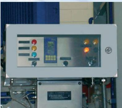
Stickstoffeindüsung und Prüfung der Atmosphäre auf den Restsauerstoffgehalt.
