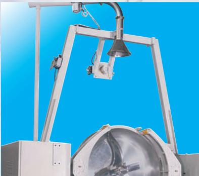
Entlüftungssystem für den Mischbehälter.
