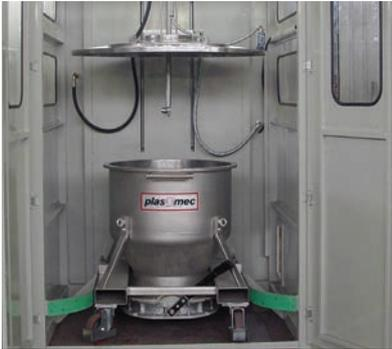
Reinigungsstation für den Container mit Heiß- oder Kaltwasser-Hochdruckstrahl.
