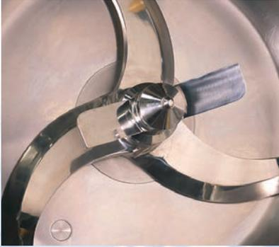
Unterschiedliche Rotationsgeschwindigkeiten des unteren (langsamen) und oberen (schnellen) Rührwerkzeugs. Geschwindigkeitsverhältnis 1:8 durch Untersetzungsgetriebe.
