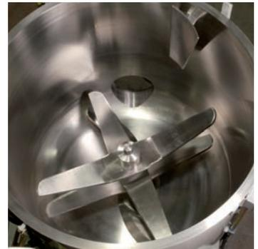
Eindüsen von Stickstoff über die Wellenabdichtung, einschließlich Restsauerstoffüberwachung.
