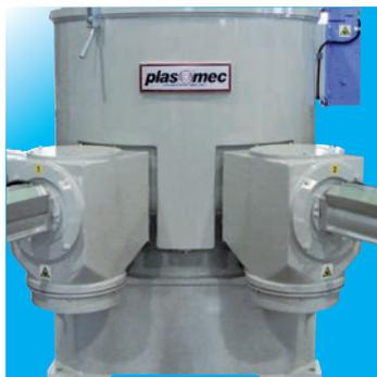
Scambiatore di calore per circolazione H<sub>2</sub>O di raffreddamento.
