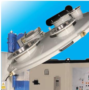
Cuve avec double/triple chemise pour chauffage.
